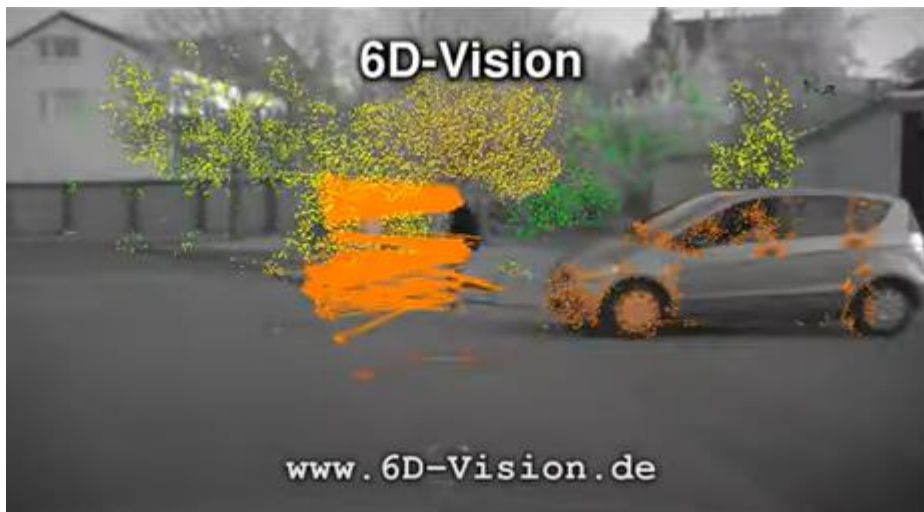
16. ábra. Mozgás előrejelzése a 6d_vision rendszerben
