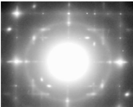
5. ábra Ag-vel szennyezett Ge egykristály elektron diffrakciós képe
