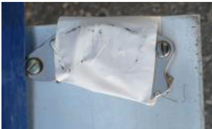
16. ábra A mágnesen (bal oldali kép) a sivatagi porból befogott vasszemcsék láthatók az elektronikán pedig rengeteg porszemcse gyűlt össze, valószínűleg elektrosztatikus feltöltődés következtében.
