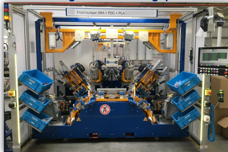
Komplex többállomásos lyukasztó, ultraszónikus hegesztő, ragasztó szerelő gépek
