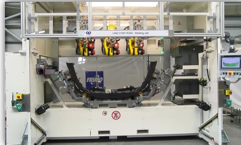
Komplex többállomásos lyukasztó, ultraszónikus hegesztő, ragasztó szerelő gépek
